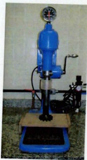
Figura 6 - Máquina marca Denver empregada nos ensaios de flotação.
